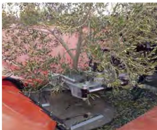
**A scelta**, possiamo montare i bracci specifici per albero giovane, che ci permetterà di eseguire le vibrazioni senza provocare nessun danno all'albero, ai tronchi che oscillano tra gli 8 e i 30 cm. La vibrazione ottenuta e i risultati di caduta saranno eccellenti.
