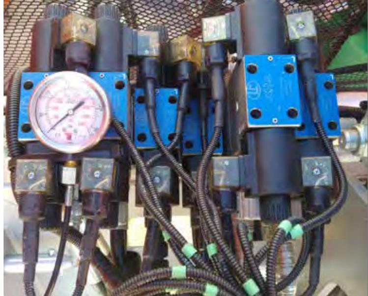
La configurazione idraulica della serie VM-XT10 TRV PNA/PGA è la seguente:
